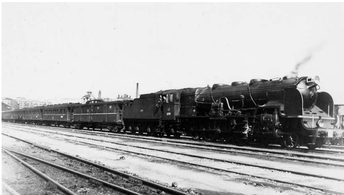
A formação original do Lusitânia Expresso em Madrid Delicias – um furgão CIWL do parque espanhol (provavelmente 1271, 1274 ou 1275), 2 Camas CIWL do tipo S4 série 3361-3380 ('curtas para a Península Ibérica', com a caixa medindo 21,550 mm em vez do standard 23,554 mm), uma mista Renfe série AAXB 1601 a 1607, e um restaurante CIWL -, circa 1944, com a tração a cargo de uma Montaña ex Norte série 241-4001 a 4097. Foto de Roger Conmault
