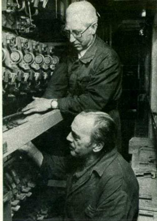
Efectuando la revisión en una locomotora eléctrica, en la nave de reparación de material eléctrico.
