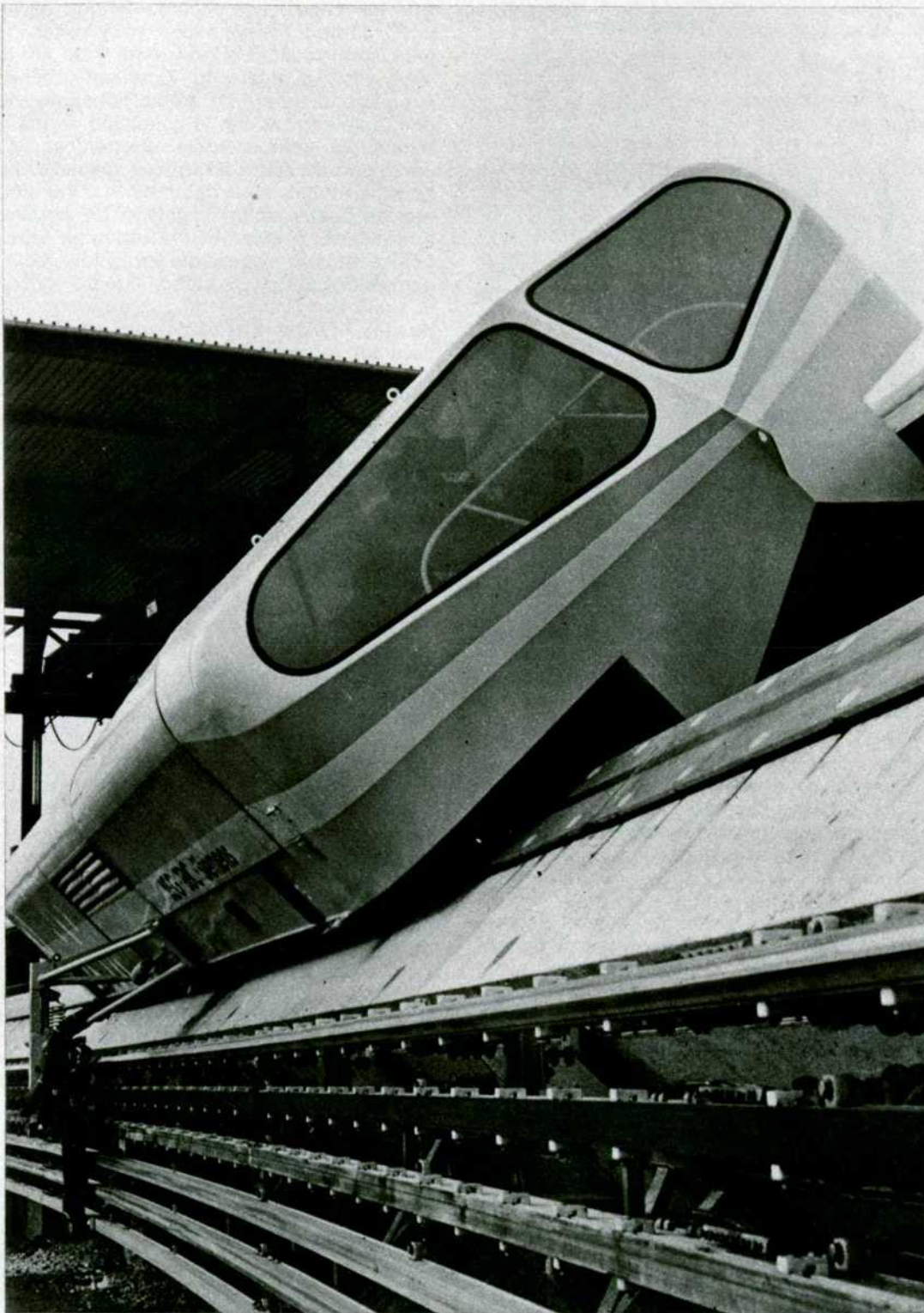
El vehículo de ensayo del Grupo de Erlangen, sin electroimanes. (Foto: AEG-BBC-Siemens.)
