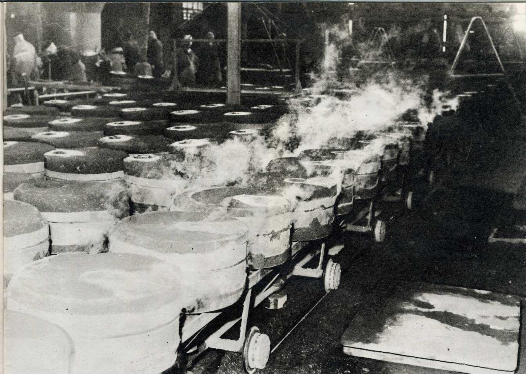
Tren continuo transportando cajas o moldes de zapatas ya fundidas. Por su interior, cajas moldeadas esperando la entrada en el tren para ser fundidas.
