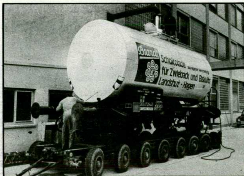
Todo es posible en el tren: la foto, del DB, presenta el primer Chocolate Exprés de Alemania. La firma Brandt ha construido un vagón cisterna, propio para transportar chocolate líquido, 25.000 kilos, de Westfalia a Baviera. En sentido inverso, el Chocolate Exprés transportará manteca de cacao.—Foto DB: Zeitler (Regensburg).
