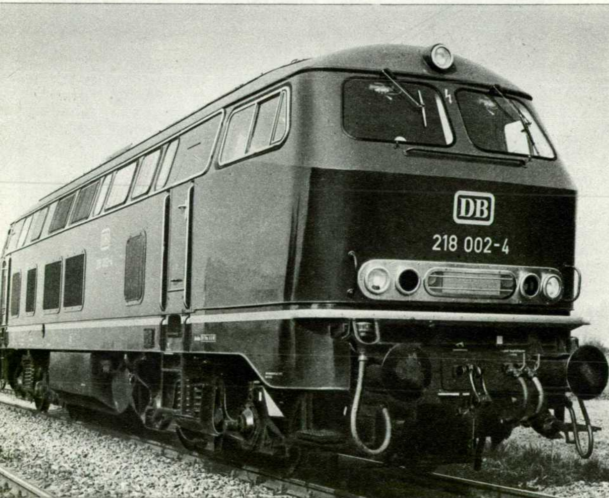
La Diesel 218 para tracción de trenes rápidos: 140 kilómetros por hora.
