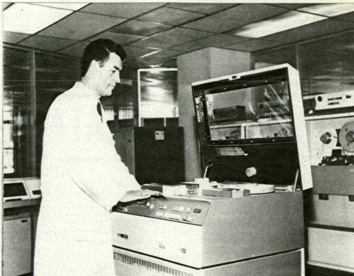
Unidad de entrada. Lectura de cinta de papel. Su capacidad oscila entre 450 y 900 caracteres por segundo.
