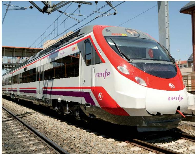
Al estar casi todos los bogies motorizados, ya que es un vehículo con motorización distribuida, las prestaciones del tren se mantienen, independientemente del número de coches que forme la unidad.
