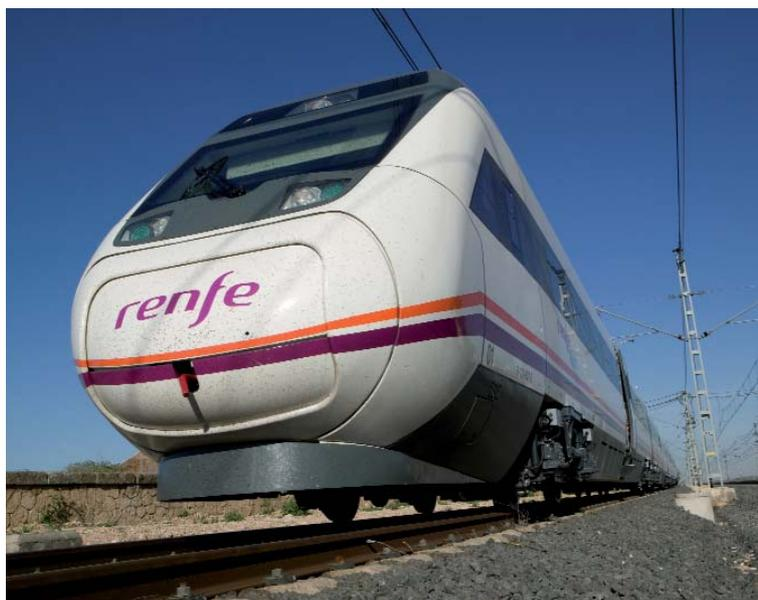
cuatro equipos, uno por coche, montados bajo bastidor. Cada uno de los equipos de propulsión dispone de dos motores eléctricos por lo que cada tren incorpora ocho motores.
