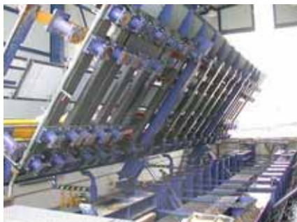
Plataforma de los cambiadores de Talgo (izquierda) y CAF (derecha). A la izquierda, plataforma abatiéndose verticalmente. A la derecha, casetas que ayudan a la portabilidad a los cambiadores de tercera generación
