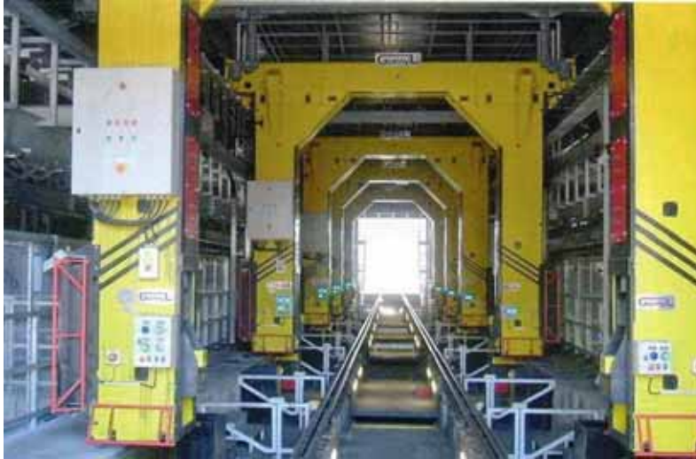
Instalación para el intercambio de ejes en los vagones de mercancías
