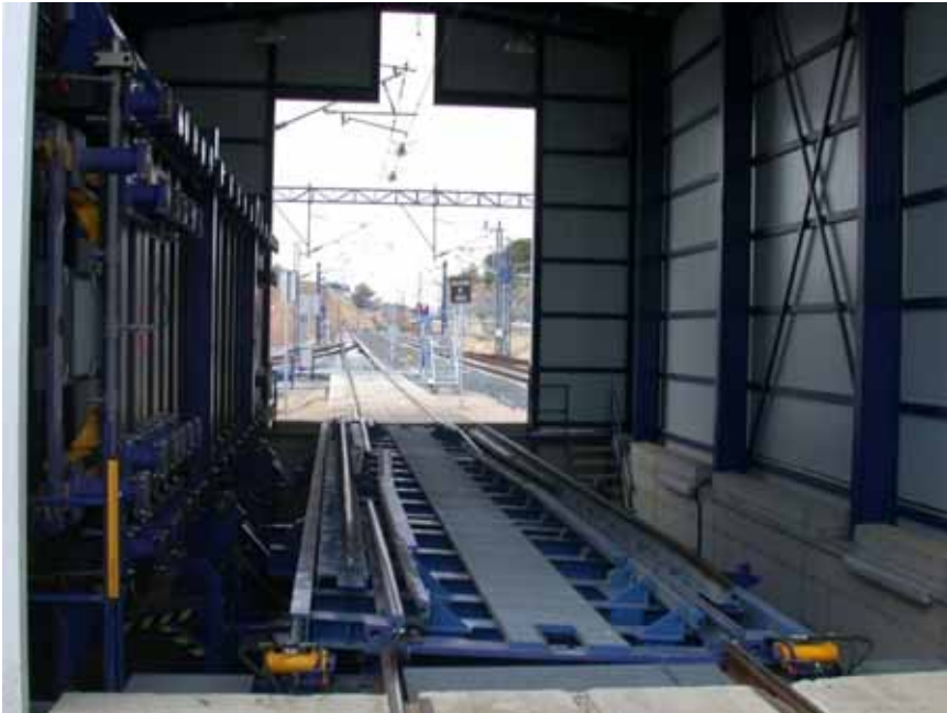
En los cambiadores de tercera generación, la catenaria pasa por el cambiador
