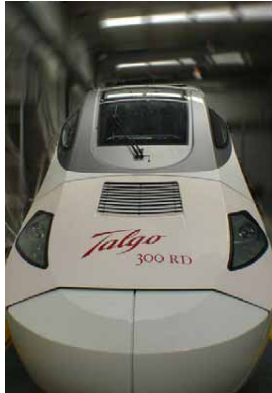
Cabeza motriz del prototipo de Talgo de ancho variable capaz de alcanzar los 300 km/h. CAF ha anunciado un tren semejante
