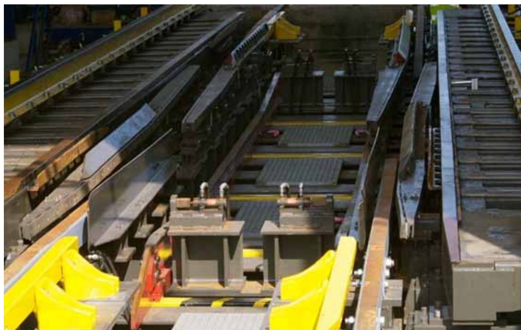
Cambiador de pruebas TCRS3 en posición CAF. Obsérvese que han bajado las guías rojas de enclavamiento Talgo y se han retirado lateralmente los carriles de apoyo.
