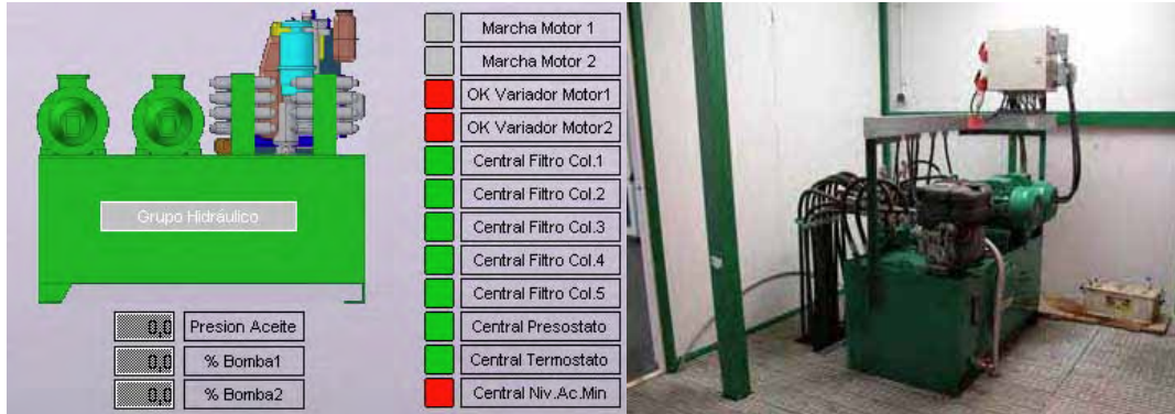
A la izquierda sistema de control, y a la derecha grupo hidráulico
