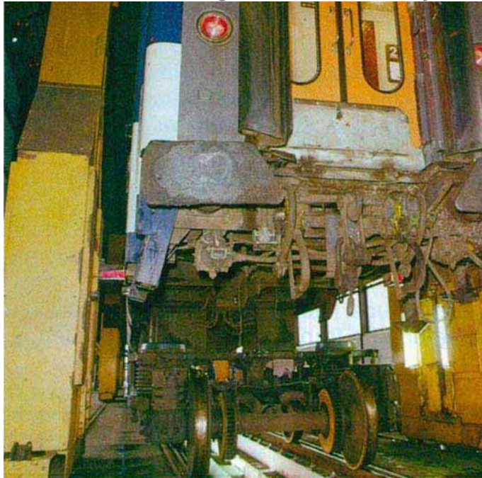
Intercambio de bogies de un coche de viajeros
