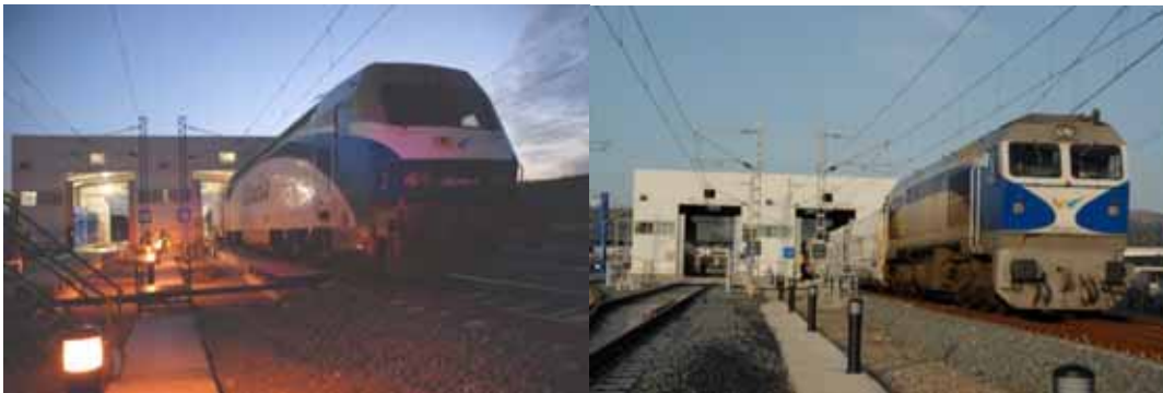
En Antequera-Santa Ana existen dos cambiadores duales (CAF y Talgo) que se utilizan para los trenes de Madrid, Algeciras y Granada
