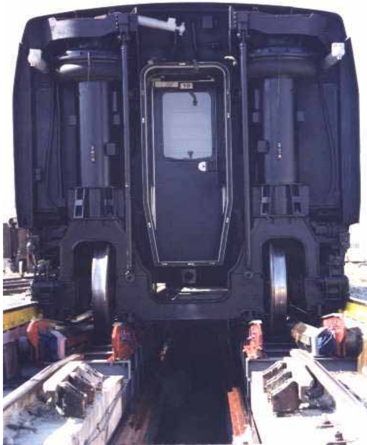
Cambio automático de ancho de vía sin cambio de ejes ni de bogies
