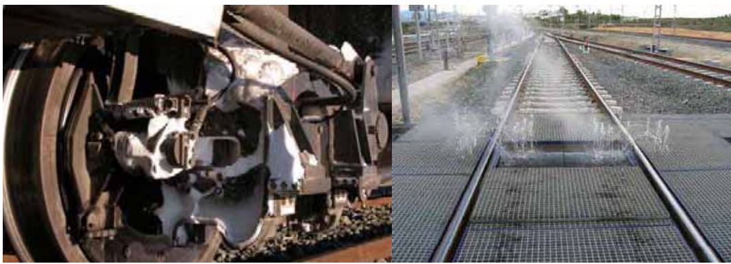
A la derecha puede verse el agua caliente expulsada por los rociadores
