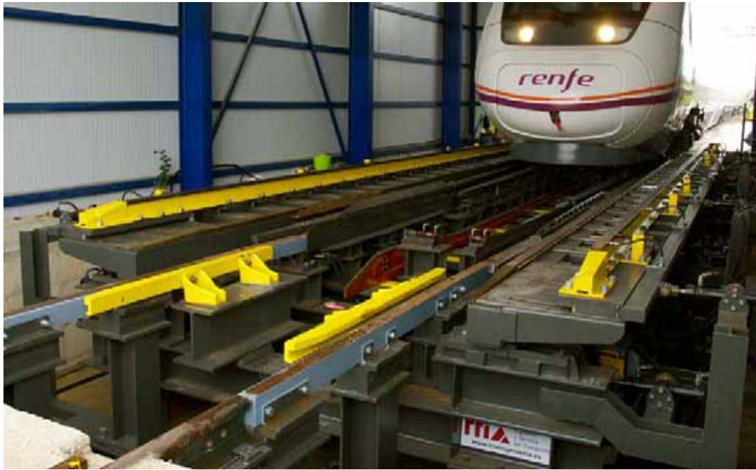
Primer tren de la serie 121 (CAF) pasando por el cambiador de pruebas el día 1 de septiembre de 2010.
