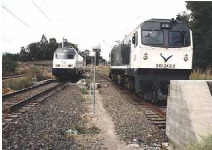
En los cambiadores de segunda generación es preciso el cambio de locomotora. En la foto, locomotoras eléctrica 252 y diésel 319 en el cambiador de Córdoba (1994).
