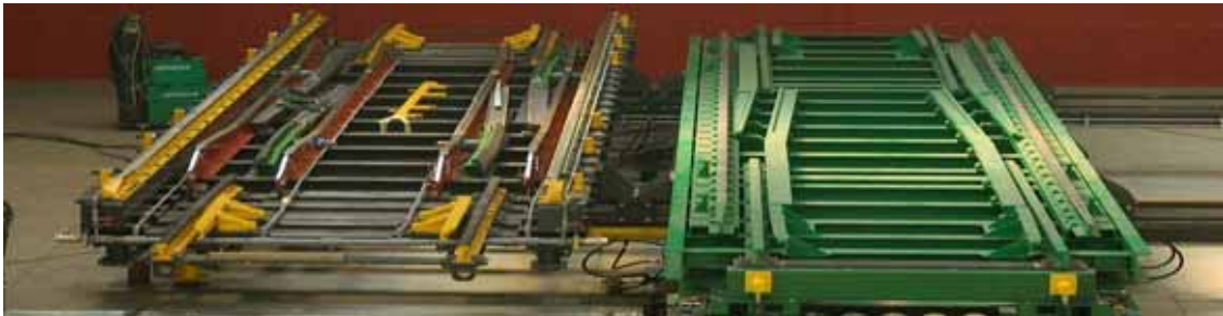
Los cambiadores de tercera generación son polivalentes y las plataformas están superpuestas a una bancada, en lugar de empotradas en un foso. En la foto, se puede ver una plataforma Talgo a la izquierda y una plataforma CAF a la derecha.
