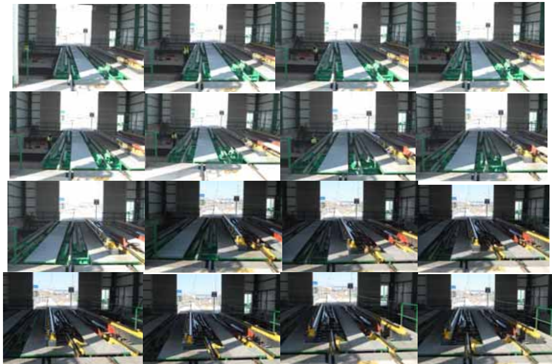
Secuencia en el cambio de plataforma de CAF (izquierda arriba) a Talgo en un cambiador horizontal, en este caso Valdestillas. (Fotos: Ana López Romero)
