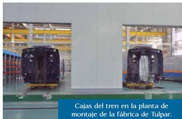
Cajas del tren en la planta de montaje de la fábrica de Tulpar.
